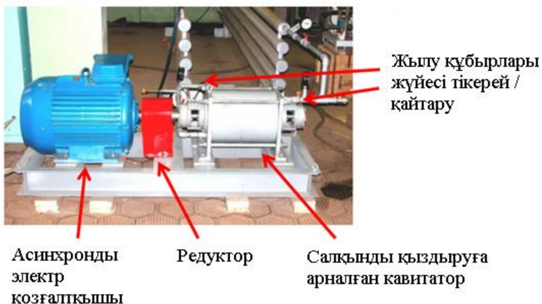
1.1 Сурет – Кавитациялық жылу генераторы
